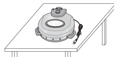
**2** タイマーが「0」、ヒーター切替スイッチが「切」の位置にあることを確認し、セラミックプレートを本体にセットする
