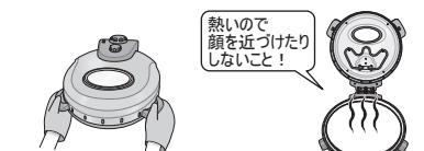
★ピザを焼く場合は、手作り生地・市販品に間わらず、ピザをのせたらすぐに20～30秒ほどピザパドルでピザを回し、セラミックプレートにくつくなってしまったことを確認してからフタを開める(生地の水分を飛ばすことで焦げつきにくくなります)
