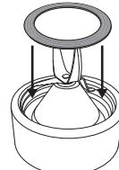
※ミキサーパッキンがないと内容物が漏れますので必ず取り付けてください。
